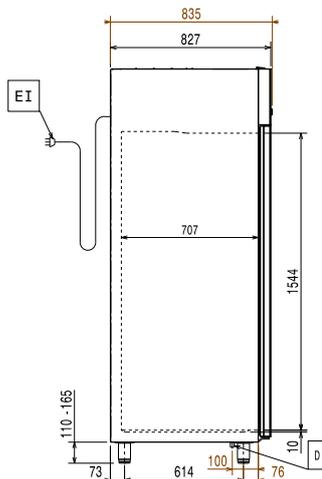
ED = separater Elektroanschluss      RO = Zentralkälteanlage-Anschluss
